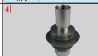
圆棒散热器 G \frac{1}{2} 使用在高温的棒式温控器。适合安装在位于外壳下面的 \frac{3}{8} " 螺纹和圆棒散热器支架的 \frac{1}{2} " 公螺纹上。 不使用在 Y0 型号上
